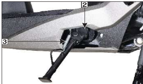
(2) Interruptor del soporte lateral (3) Resorte
