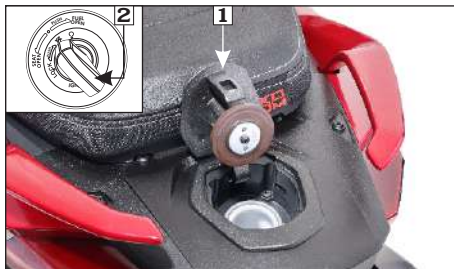
(1) Tapa del depósito de combustible (2) Llave de encendido
