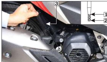
(1) Marca nivel superior (2) Marca nivel inferior (3) Varilla de nivel de aceite
