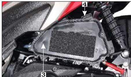
(3) Componente del soporte del elemento (4) Caja del subconjunto del filtro de aire
