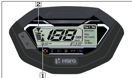
(1) Indicador de combustible (2) Segmentos
