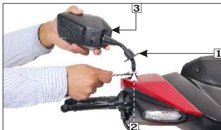
(1) Guarda polvo (2) Tuerca especial (3) Espejo retrovisor
