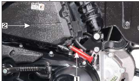
(1) Tubo de drenaje (2) Conjunto de filtro
