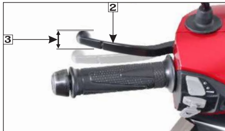
(2) Palanca freno integrado
