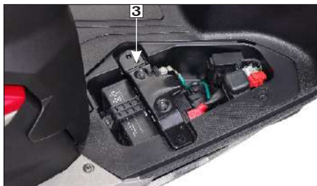
(3) Soporte del panel del piso
