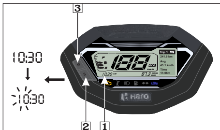
(1) Reloj digital 2) Botón de ajuste (3) Botón de modo
