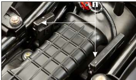
(1) Cajas de fusibles
