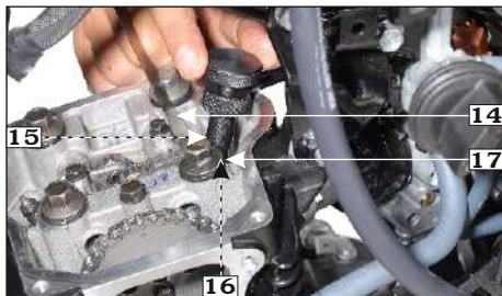
(14) Calibrador de espesores (15) Tornillo de ajuste (16) Vástago de válvula (17) Contratuerca
