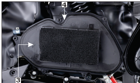
(3) Soporte del elemento del filtro de aire (4) Caja del subconjunto del filtro de aire
