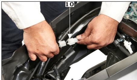
(10) Conector luz trasera/de freno
