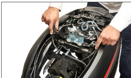
(10) Conector luz trasera/de freno
