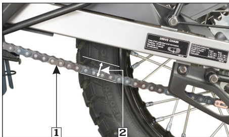
(1) Cadena de transmisión (2) Holgura: 30–35 mm
