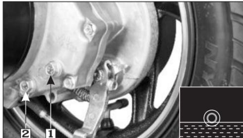
(1) Perno de control (2) Perno de drenaje
