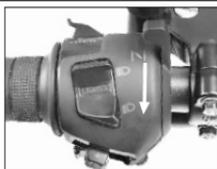
5. Tire de la palanca de Bystarter hacia abajo como se indica (Use Bystarter en condiciones de frío)
