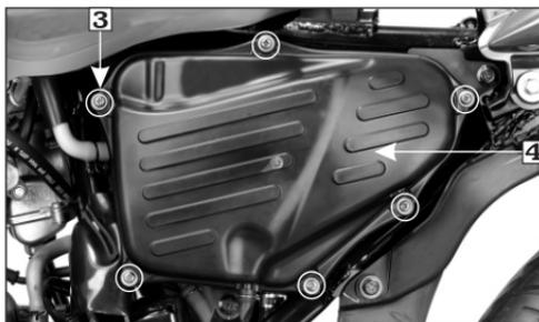
(3) Tornillos/arandelas cubierta filtro de aire
