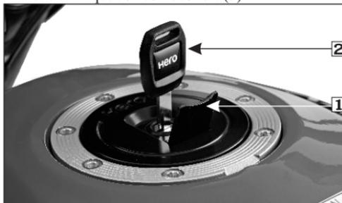
**(1) Tapa del orificio (2) Llave de encendido**
